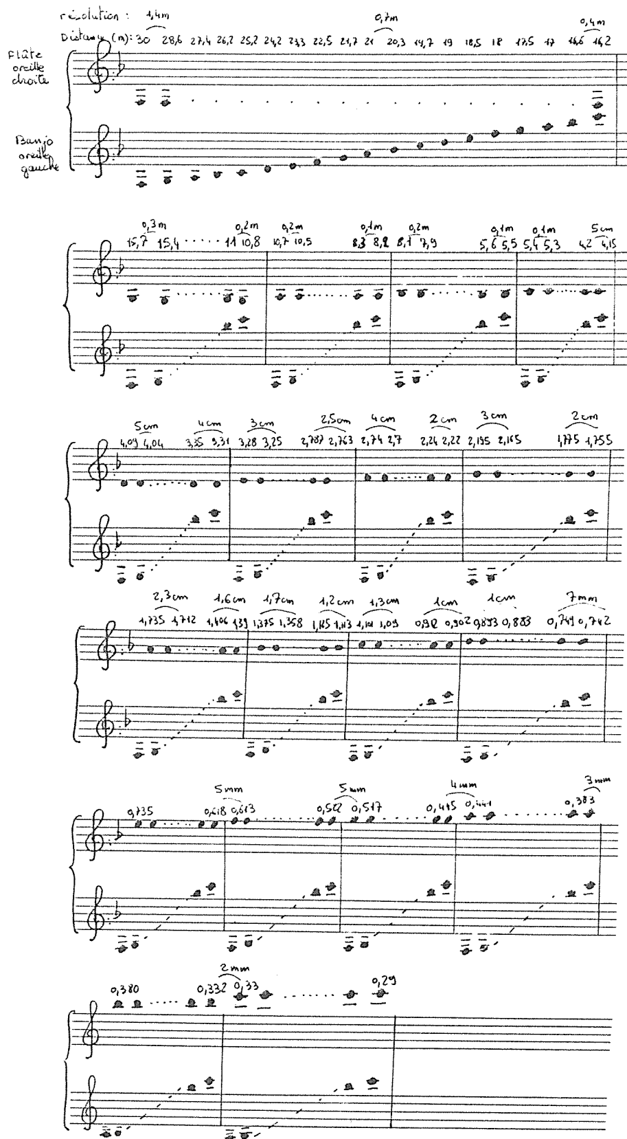
Figure III - 2 : Correspondance entre les distances et les couples de notes sur portée musicale, la précision de l'échelle en distance est spécifiée pour les différentes plages de mesure.
