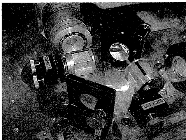
Fig. 4.15: Photographie du dispositif avec les cubes polarisants pour l'obtention de deux pièges optiques simultanés.
