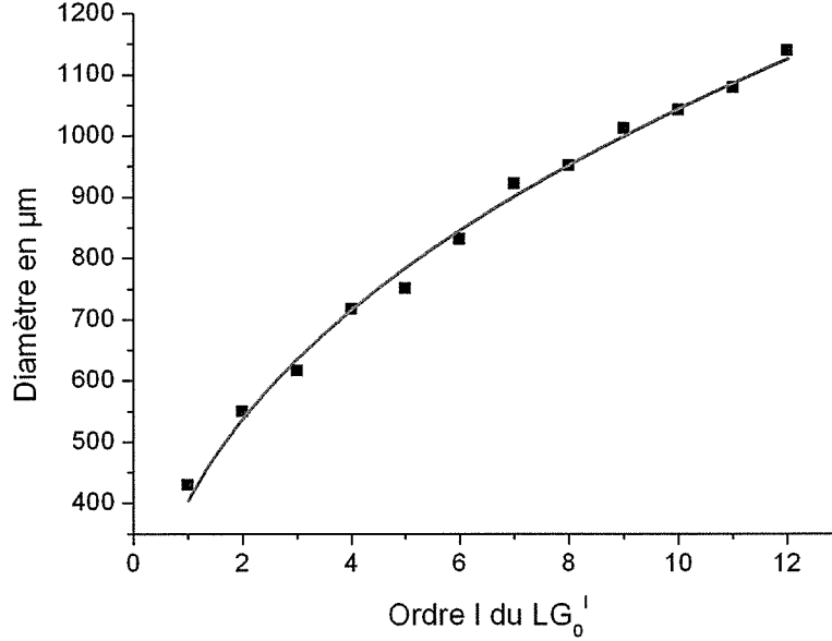
FIGURE 4.12 – Diamètre des LG_0^l en fonction de l'ordre l du LG pour un LG agrandi avec une lentille de 5 mètres de focale. Courbe rouge : ajustement avec une fonction k_1 * l^k où k_1 et k sont des constantes. Ici k_1 = 404 \mu m et k = 0.41 ce qui équivaut à w \approx 290 \mu m .
