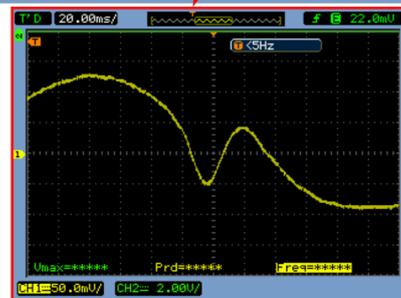
On obtient un signal d'erreur de 100mV assez stable ce qui n'était pas possible avec l'ancien montage.
